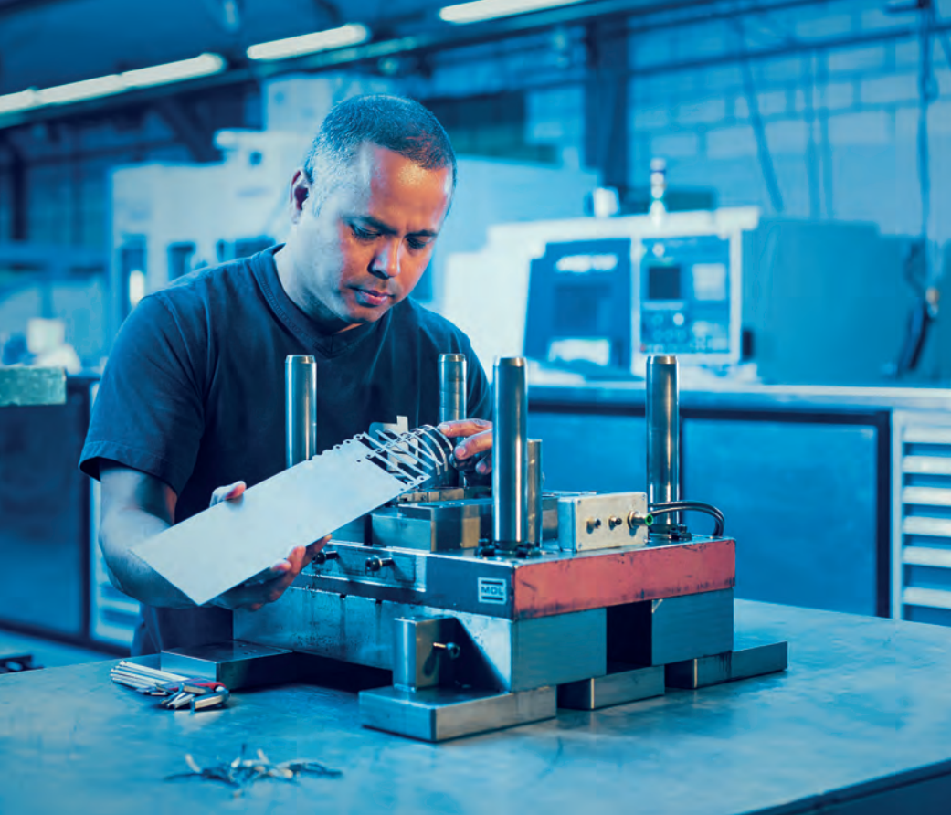
Inspectie van een stempel die de waaierschoppen vormt.
