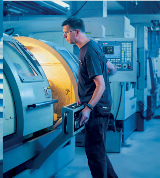
Onderdelen voor een nieuwe RVS mal worden bewerkt in de draaibank.
